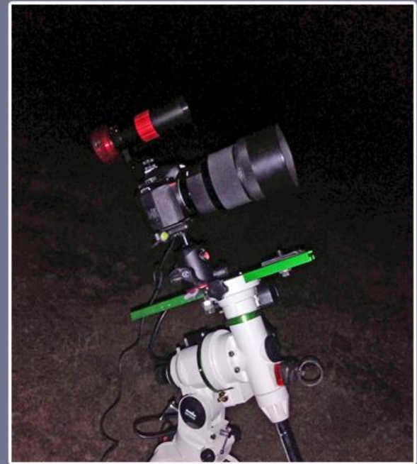
Ejemplo de acoplamiento de una cámara reflex con una lente fotográfica a una montura ecuatorial.
