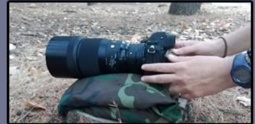
En estas fotografías puede comprobarse la versatilidad de apoyo de un saco relleno de legumbres secas para apoyar un equipo a ras de suelo o en la ventana del coche y en el techo. Son buenos sistemas de estabilización alternativos al trípode.
